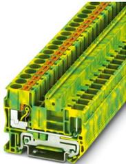
Schutzleiter-Reihenklemme, Anzahl der Anschlüsse: 2, Anschlussart: Push-in- / Steckanschluss, Querschnitt: 0,5 mm<sup>2</sup> - 10 mm<sup>2</sup>, Montageart: NS 35/7,5, NS 35/15, Farbe: grün-gelb
