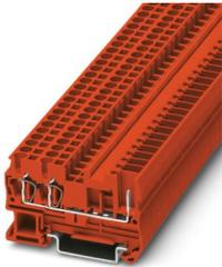
Durchgangsklemme, Nennspannung: 500 V, Nennstrom: 24 A, Anzahl der Anschlüsse: 3, Polzahl: 1, Anschlussart: Zugfeder- / Steckanschluss, Bemessungsquerschnitt: 2,5 mm<sup>2</sup>, 1. Etage Anschluss links, Querschnitt: 0,08 mm<sup>2</sup> - 4 mm<sup>2</sup>, 1. Etage Anschluss rechts, Montageart: NS 35/7,5, NS 35/15, Farbe: rot
