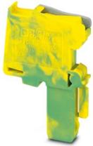
Stecker, Nennspannung: 500 V, Nennstrom: 24 A, Polzahl: 1, Anschlussart: Zugfederanschluss, Bemessungsquerschnitt: 2,5 mm<sup>2</sup>, Querschnitt: 0,08 mm<sup>2</sup>- 4 mm<sup>2</sup>, Farbe: grün-gelb
