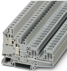
Durchgangsklemme, Nennspannung: 1000 V, Nennstrom: 41 A, Anzahl der Anschlüsse: 4, Anschlussart: Schraub- / Steckanschluss, Bemessungsquerschnitt: 6 mm<sup>2</sup>, Querschnitt: 0,2 mm<sup>2</sup> - 10 mm<sup>2</sup>, Montageart: NS 35/7,5, NS 35/15, Farbe: grau
