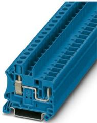
Durchgangsklemme, Nennspannung: 1000 V, Nennstrom: 41 A, Anzahl der Anschlüsse: 2, Anschlussart: Schraub- / Steckanschluss, Bemessungsquerschnitt: 6 mm<sup>2</sup>, Querschnitt: 0,2 mm<sup>2</sup> - 10 mm<sup>2</sup>, Montageart: NS 35/7,5, NS 35/15, Farbe: blau
