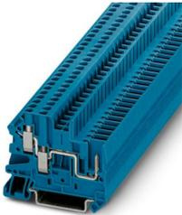
Durchgangsklemme, Nennspannung: 500 V, Nennstrom: 24 A, Anzahl der Anschlüsse: 3, Polzahl: 1, Anschlussart: Schraub- / Steckanschluss, Bemessungsquerschnitt: 2,5 mm<sup>2</sup>, Querschnitt: 0,14 mm<sup>2</sup> - 4 mm<sup>2</sup>, Montageart: NS 35/7,5, NS 35/15, Farbe: blau
