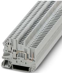
Durchgangsklemme, Nennspannung: 500 V, Nennstrom: 24 A, Anzahl der Anschlüsse: 3, Polzahl: 1, Anschlussart: Schraub- / Steckanschluss, Bemessungsquerschnitt: 2,5 mm<sup>2</sup>, Querschnitt: 0,14 mm<sup>2</sup> - 4 mm<sup>2</sup>, Montageart: NS 35/7,5, NS 35/15, Farbe: grau
