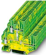
Schutzleiter-Doppelstockklemme, Strom und Spannung werden durch den eingesetzten Stecker bestimmt., Anschlussart: Schraub- / Steckanschluss, Querschnitt: 0,14 mm<sup>2</sup> - 4 mm<sup>2</sup>, Montageart: NS 35/7,5, NS 35/15, Farbe: grün-gelb
