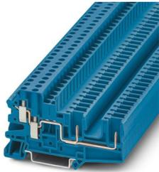
Durchgangsklemme, Nennspannung: 500 V, Nennstrom: 32 A, Anzahl der Anschlüsse: 4, Anschlussart: Schraub- / Steckanschluss, Bemessungsquerschnitt: 4 mm<sup>2</sup>, Querschnitt: 0,14 mm<sup>2</sup> - 6 mm<sup>2</sup>, Montageart: NS 35/7,5, NS 35/15, Farbe: blau
