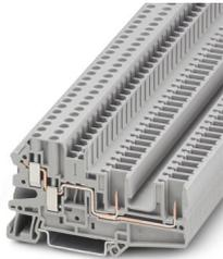
Durchgangsklemme, Nennspannung: 500 V, Nennstrom: 32 A, Anzahl der Anschlüsse: 4, Anschlussart: Schraub- / Steckanschluss, Bemessungsquerschnitt: 4 mm<sup>2</sup>, Querschnitt: 0,14 mm<sup>2</sup> - 6 mm<sup>2</sup>, Montageart: NS 35/7,5, NS 35/15, Farbe: grau
