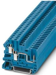
Durchgangsklemme, Nennspannung: 500 V, Nennstrom: 32 A, Anzahl der Anschlüsse: 3, Polzahl: 1, Anschlussart: Schraub- / Steckanschluss, Bemessungsquerschnitt: 4 mm<sup>2</sup>, Querschnitt: 0,14 mm<sup>2</sup> - 6 mm<sup>2</sup>, Montageart: NS 35/7,5, NS 35/15, Farbe: blau
