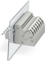
Durchführungsklemme, Anschlussart: Push-in-Federanschluss, Lötanschluss, Polzahl: 1, Belastungsstrom: 32 A, Querschnitt: 0,2 mm<sup>2</sup> - 4 mm<sup>2</sup>, Anschlussrichtung des Leiters zur Steckrichtung: 45 °, Breite: 8,1 mm, Farbe: grau
