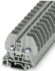
Durchgangsklemme mit Bolzenanschlusstechnik, Querschnitt: 0,1 - 10 mm<sup>2</sup>, AWG: 26 - 8, Breite 13 mm, Farbe: grau
