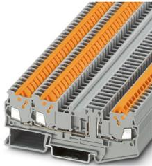
Trennklemme, Nennspannung: 400 V, Nennstrom: 17,5 A, Anzahl der Anschlüsse: 3, Anschlussart: Schnellanschluss, Bemessungsquerschnitt: 1,5 mm<sup>2</sup>, 1. Etage, Querschnitt: 0,25 mm<sup>2</sup> - 1,5 mm<sup>2</sup>, Montageart: NS 35/7,5, NS 35/15, Farbe: grau
