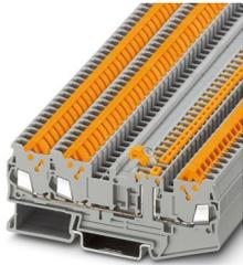
Messertrennklemme, Nennspannung: 400 V, Nennstrom: 17,5 A, 1. Etage, Anschlussart: Schnellanschluss, Bemessungsquerschnitt: 1,5 mm<sup>2</sup>, Querschnitt: 0,25 mm<sup>2</sup> - 1,5 mm<sup>2</sup>, Montage: NS 35/7,5, NS 35/7,5, Farbe: grau
