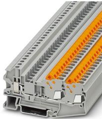
Durchgangsklemme, Nennspannung: 800 V, Nennstrom: 24 A, Anschlussart: Schnellanschluss, Bemessungsquerschnitt: 2,5 mm<sup>2</sup>, Querschnitt: 0,5 mm<sup>2</sup> - 2,5 mm<sup>2</sup>, Anschlussart: Schraubanschluss, Bemessungsquerschnitt: 2,5 mm<sup>2</sup>, Querschnitt: 0,14 mm<sup>2</sup> - 6 mm<sup>2</sup>, Montage: NS 35/7,5, NS 35/15, Farbe: grau
