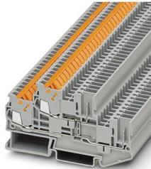
Doppelstockklemme, Strom und Spannung werden durch den eingesetzten Stecker bestimmt., Nennspannung: 500 V, Nennstrom: 17,5 A, Anschlussart: Schnell- / Steckanschluss, Bemessungsquerschnitt: 1,5 mm<sup>2</sup>, Querschnitt: 0,25 mm<sup>2</sup> - 1,5 mm<sup>2</sup>, Montageart: NS 35/7,5, NS 35/15, Farbe: grau
