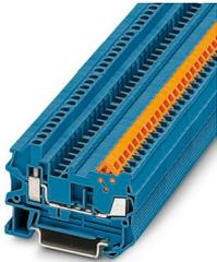
Durchgangsklemme, Nennspannung: 800 V, Nennstrom: 17,5 A, Anschlussart: Schnellanschluss, Bemessungsquerschnitt: 1,5 mm<sup>2</sup>, Querschnitt: 0,25 mm<sup>2</sup> - 1,5 mm<sup>2</sup>, Anschlussart: Schraubanschluss, Bemessungsquerschnitt: 1,5 mm<sup>2</sup>, Querschnitt: 0,14 mm<sup>2</sup> - 4 mm<sup>2</sup>, Montage: NS 35/7,5, NS 35/15, Farbe: blau
