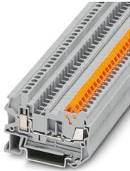
Durchgangsklemme, Nennspannung: 800 V, Nennstrom: 17,5 A, Anschlussart: Schnellanschluss, Bemessungsquerschnitt: 1,5 mm<sup>2</sup>, Querschnitt: 0,25 mm<sup>2</sup> - 1,5 mm<sup>2</sup>, Anschlussart: Schraubanschluss, Bemessungsquerschnitt: 1,5 mm<sup>2</sup>, Querschnitt: 0,14 mm<sup>2</sup> - 4 mm<sup>2</sup>, Montage: NS 35/7,5, NS 35/15, Farbe: grau
