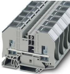
Durchgangsklemme mit Bolzenanschlusstechnik und transparenter Berührungsschutzhaube, Querschnitt: 2,5 - 35 mm<sup>2</sup>, AWG: 14 - 2, Breite 20,2 mm, Farbe: grau
