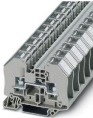
Durchgangsklemme, Nennspannung: 1000 V, Nennstrom: 41 A, Anzahl der Anschlüsse: 2, Anschlussart: Bolzenanschluss, Bemessungsquerschnitt: 6 mm<sup>2</sup>, 1. Etage, Montageart: NS 35/7,5, NS 35/15, Farbe: grau
