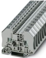
Durchgangsklemme mit Bolzenanschlusstechnik und transparenter Berührungsschutzhaube, Querschnitt: 0,1 - 2,5 mm<sup>2</sup>, AWG: 26 - 14, Breite 12,3 mm, Farbe: grau
