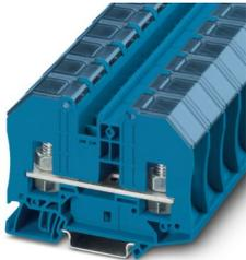
Durchgangsklemme mit Bolzenanschlusstechnik und transparenter Berührungsschutzhaube, Querschnitt: 2,5 - 35 mm<sup>2</sup>, AWG: 14 - 2, Breite 20,2 mm, Farbe: blau
