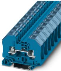
Durchgangsklemme mit Bolzenanschlusstechnik und transparenter Berührungsschutzhaube, Querschnitt: 0,1 - 6 mm<sup>2</sup>, AWG: 26 - 10, Breite 16,3 mm, Farbe: blau
