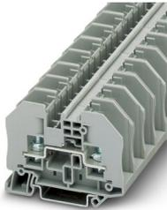
Bolzenanschlussklemme, Nennspannung: 1000 V, Nennstrom: 41 A, Anzahl der Anschlüsse: 2, Anschlussart: Bolzenanschluss, Bemessungsquerschnitt: 6 mm<sup>2</sup>, 1. Etage, Montageart: NS 35/7,5, NS 35/15, Farbe: grau
