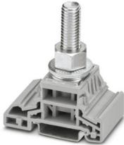
Hochstromverbinder, Nennspannung: 1000 V, Nennstrom: 269 A, Anzahl der Anschlüsse: 1, Anschlussart: Bolzenanschluss, Bemessungsquerschnitt: 120 mm<sup>2</sup>, Montageart: NS 35/7,5, NS 35/15, Farbe: grau
