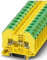
Schutzleiter-Reihenklemme, Achtung: bei nicht isolierten Kabelschuhen ist die Streckenverlängerung BE-RT... (siehe Zubehör) einzusetzen!, Nennspannung: 1000 V, Nennstrom: 24 A, Anzahl der Anschlüsse: 2, Anschlussart: Bolzenanschluss, 1. Etage, Bemessungsquerschnitt: 2,5 mm<sup>2</sup>, Montageart: NS 35/7,5, NS 35/15, Farbe: grün-gelb
