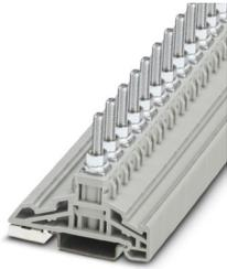
Hochstromverbinder, Nennspannung: 1000 V, Nennstrom: 76 A, Anzahl der Anschlüsse: 1, Anschlussart: Bolzenanschluss, Bemessungsquerschnitt: 16 mm<sup>2</sup>, Montageart: NS 35/7,5, NS 35/15, Farbe: grau
