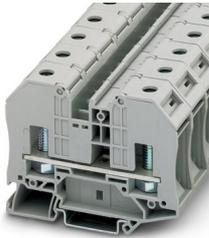
Bolzenanschlussklemme, Nennspannung: 1000 V, Nennstrom: 125 A, Anzahl der Anschlüsse: 2, Polzahl: 1, Anschlussart: Bolzenanschluss, Bemessungsquerschnitt: 35 mm<sup>2</sup>, Montageart: NS 35/7,5, NS 35/15, Farbe: grau
