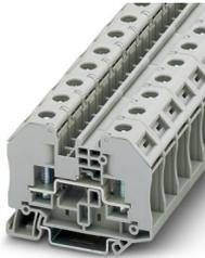
Bolzenanschlussklemme, Nennspannung: 1000 V, Nennstrom: 41 A, Anzahl der Anschlüsse: 2, Anschlussart: Bolzenanschluss, Bemessungsquerschnitt: 6 mm<sup>2</sup>, Montageart: NS 35/7,5, NS 35/15, Farbe: grau
