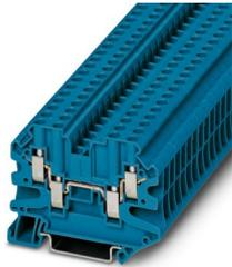
Vierleiter-Universalklemme, Nennspannung: 1000 V, Nennstrom: 32 A, Anzahl der Anschlüsse: 4, Anschlussart: Schraubanschluss, Bemessungsquerschnitt: 4 mm<sup>2</sup>, Querschnitt: 0,14 mm<sup>2</sup> - 6 mm<sup>2</sup>, Montageart: NS 35/7,5, NS 35/15, Farbe: blau
