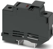
Sicherungsreihenklemme, Art der Sicherung: Glas / Keramik / ..., Sicherungstyp: Class CC, Nennspannung: 72 V, Nennstrom: 30 A, Anschlussart: Schraubanschluss, Bemessungsquerschnitt: 16 mm<sup>2</sup>, Querschnitt: 1 mm<sup>2</sup>- 16 mm<sup>2</sup>, Montageart: NS 35/7,5, NS 35/15, Farbe: schwarz
