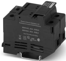
Sicherungshalter, Art der Sicherung: Keramik, Sicherungstyp: Class CC, Nennspannung: 600 V, Nennstrom: 30 A, Polzahl: 2, Anschlussart: Schraubanschluss, Bemessungsquerschnitt: 16 mm<sup>2</sup>, Querschnitt: 1 mm<sup>2</sup>- 16 mm<sup>2</sup>, Montageart: NS 35/7,5, NS 35/15, Farbe: schwarz
