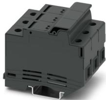
Sicherungshalter, Art der Sicherung: Keramik, Sicherungstyp: 10,3 x 38 mm, Nennspannung: 690 V AC, Nennstrom: 32 A, Polzahl: 3, Anschlussart: Schraubanschluss, Bemessungsquerschnitt: 16 mm<sup>2</sup>, Querschnitt: 1 mm<sup>2</sup>- 16 mm<sup>2</sup>, Montageart: NS 35/7,5, NS 35/15, Farbe: schwarz
