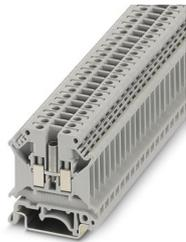
Durchgangsklemme, Nennspannung: 800 V, Nennstrom: 32 A, Anzahl der Anschlüsse: 2, Anschlussart: Schraubanschluss, Bemessungsquerschnitt: 4 mm<sup>2</sup>, Querschnitt: 0,2 mm<sup>2</sup> - 6 mm<sup>2</sup>, Montageart: NS 35/7,5, NS 35/15, NS 32, Farbe: grau
