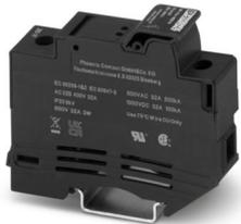
Sicherungsreihenklemme, Art der Sicherung: Keramik, Sicherungstyp: 10,3 x 38 mm, Nennspannung: 690 V AC, Nennstrom: 32 A, Polzahl: 1, Anschlussart: Schraubanschluss, Bemessungsquerschnitt: 16 mm<sup>2</sup>, Querschnitt: 1 mm<sup>2</sup>- 16 mm<sup>2</sup>, Montageart: NS 35/7,5, NS 35/15, Farbe: schwarz
