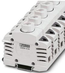
Sicherungsreihenklemme, Art der Sicherung: Schraubpatrone, Sicherungstyp: D 01 / E 14, Nennspannung: 400 V, Nennstrom: 16 A, Anschlussart: Schraubanschluss, Bemessungsquerschnitt: 35 mm<sup>2</sup>, Querschnitt: 1,5 mm<sup>2</sup>- 35 mm<sup>2</sup>, Montageart: NS 35/7,5, NS 35/15, Farbe: hellgrau
