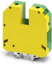
Schutzleiter-Reihenklemme, Schrauben mit Innensechskant, mit Ausbruch zur Brückung, ohne Befestigungsschraube, Anzahl der Anschlüsse: 2, Polzahl: 1, Anschlussart: Schraubanschluss, Bemessungsquerschnitt: 95 mm<sup>2</sup>, Querschnitt: 25 mm<sup>2</sup> - 95 mm<sup>2</sup>, Montageart: NS 35/7,5, NS 35/15, NS 32, Farbe: grün-gelb
