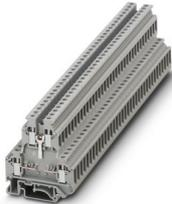
Bauelementreihenklemme, Maximale Breite der einzulötenden Bauteile: 5 mm, Nennspannung: 500 V, Nennstrom: 32 A, 1. und 2. Etage, Anschlussart: Schraubanschluss, Bemessungsquerschnitt: 4 mm<sup>2</sup>, Querschnitt: 0,2 mm<sup>2</sup> - 4 mm<sup>2</sup>, Montage: NS 35/7,5, NS 35/15, NS 32, Farbe: grau
