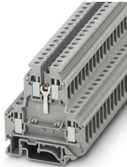
Bauelementreihenklemme, Maximale Breite der einzulötenden Bauteile: 5 mm, zum Einbau von selbst wählbaren Bauelementen, Nennspannung: 500 V, Nennstrom: 32 A, 1. und 2. Etage, Anschlussart: Schraubanschluss, Bemessungsquerschnitt: 4 mm<sup>2</sup>, Querschnitt: 0,2 mm<sup>2</sup> - 4 mm<sup>2</sup>, Montage: NS 35/7,5, NS 35/15, NS 32, Farbe: grau
