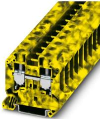
Durchgangsklemme, Nennspannung: 1000 V, Nennstrom: 76 A, Anzahl der Anschlüsse: 2, Anschlussart: Schraubanschluss, Bemessungsquerschnitt: 16 mm<sup>2</sup>, Querschnitt: 1,5 mm<sup>2</sup> - 25 mm<sup>2</sup>, Montageart: NS 35/7,5, NS 35/15, Farbe: schwarz/gelb
