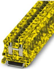
Durchgangsklemme, Nennspannung: 1000 V, Nennstrom: 57 A, Anzahl der Anschlüsse: 2, Anschlussart: Schraubanschluss, Bemessungsquerschnitt: 10 mm<sup>2</sup>, Querschnitt: 0,5 mm<sup>2</sup> - 16 mm<sup>2</sup>, Montageart: NS 35/7,5, NS 35/15, Farbe: schwarz/gelb
