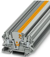
Messwandler-Trennklemme, Nennspannung: 500 V, Nennstrom: 28 A, Thermischer Dauerstrom  $I_{th}$ : 28 A, Anschlussart: Schraubanschluss, Bemessungsquerschnitt: 4 mm<sup>2</sup>, Querschnitt: 0,14 mm<sup>2</sup> - 6 mm<sup>2</sup>, Montage: NS 35/7,5, NS 35/15, Farbe: grau
