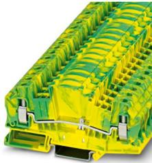
Schutzleiter-Reihenklemme, Anzahl der Anschlüsse: 2, Anschlussart: Schraubanschluss, Querschnitt: 0,2 mm<sup>2</sup> - 10 mm<sup>2</sup>, Montageart: NS 35/7,5, NS 35/15, Farbe: grün-gelb
