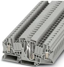
Messwandler-Trennklemme, Nennspannung: 500 V, Nennstrom: 30 A, Anzahl der Anschlüsse: 2, Anschlussart: Schraubanschluss, Bemessungsquerschnitt: 6 mm<sup>2</sup>, 1. Etage, Querschnitt: 0,2 mm<sup>2</sup> - 10 mm<sup>2</sup>, Montageart: NS 35/7,5, NS 35/15, Farbe: grau
