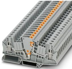
Messwandler-Trennklemme, Nennspannung: 500 V, Nennstrom: 30 A, 1. Etage, Anschlussart: Schraubanschluss, Bemessungsquerschnitt: 6 mm<sup>2</sup>, Querschnitt: 0,2 mm<sup>2</sup> - 10 mm<sup>2</sup>, Montage: NS 35/7,5, NS 35/15, Farbe: grau
