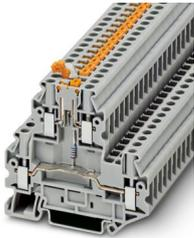
Messertrennklemme, mit Prüfbuchsen-schrauben zur Aufnahme von Prüfsteckern, Nennspannung: 24 V, Nennstrom: 30 A, Anschlussart: Schraubanschluss, Bemessungsquerschnitt: 4 mm<sup>2</sup>, Querschnitt: 0,14 mm<sup>2</sup> - 6 mm<sup>2</sup>, Anschlussart: Schraubanschluss, Bemessungsquerschnitt: 4 mm<sup>2</sup>, Querschnitt: 0,14 mm<sup>2</sup> - 6 mm<sup>2</sup>, Montage: NS 35/7,5, NS 35/15, Farbe: grau
