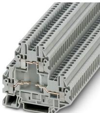
Durchgangsklemme, zum Einbau von selbst wählbaren Bauelementen, Nennspannung: 500 V, Nennstrom: 24 A, Anschlussart: Schraubanschluss, Bemessungsquerschnitt: 2,5 mm<sup>2</sup>, Querschnitt: 0,14 mm<sup>2</sup> - 4 mm<sup>2</sup>, Montageart: NS 35/7,5, NS 35/15, Farbe: grau
