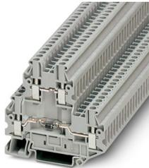
Bauelementreihenklemme, Der max. Strom wird durch die Diode bestimmt. Eingebaut: Diode 1N 4007, Sperrspannung: 1300 V, Dauergrenzstrom: 0,5 A., mit integrierter Diode, Nennstrom: 0,5 A, Anschlussart: Schraubanschluss, 1. und 2. Etage, Bemessungsquerschnitt: 2,5 mm<sup>2</sup>, Querschnitt: 0,14 mm<sup>2</sup> - 4 mm<sup>2</sup>, Montageart: NS 35/7,5, NS 35/15, Farbe: grau
