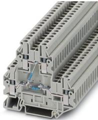
Bauelementreihenklemme, Anschlussart: Schraubanschluss, 1. und 2. Etage, Bemessungsquerschnitt: 2,5 mm<sup>2</sup>, Querschnitt: 0,14 mm<sup>2</sup> - 4 mm<sup>2</sup>, Montageart: NS 35/7,5, NS 35/15, Farbe: grau
